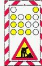
Semnalizarea unui utilaj care se deplasează lucrând
