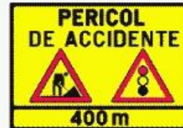
Presemnalizarea unui sector cu circulație alternantă
