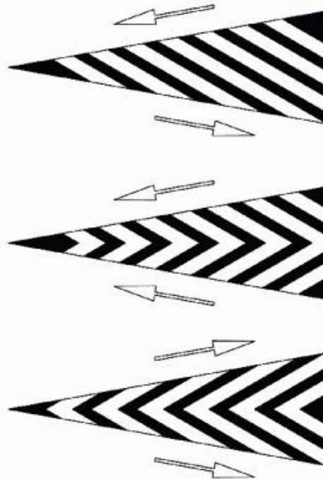
Spații interzise circulației
